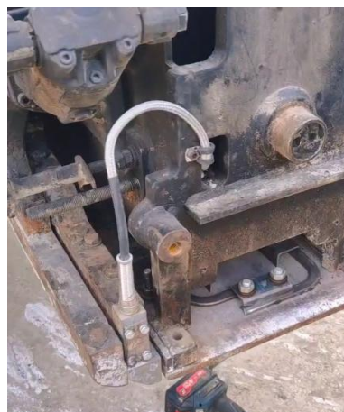
图 9-2 改造后的电加热系统
