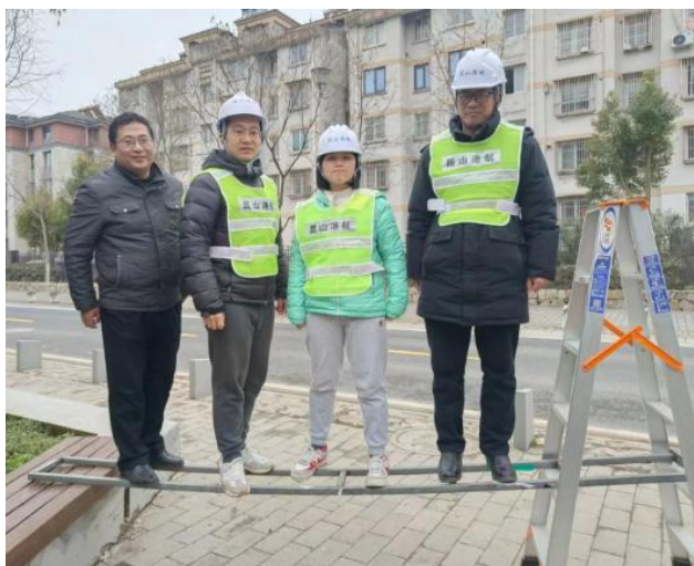
图3 站板强度试验图
