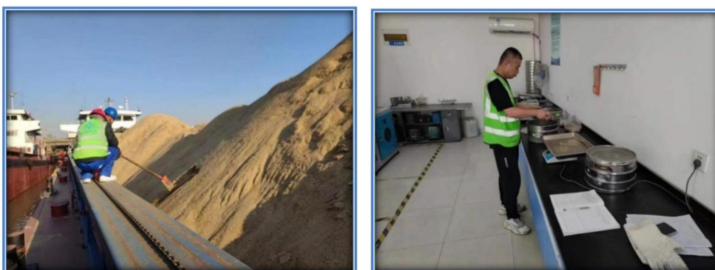
图 7-6 到船砂取样及检测
