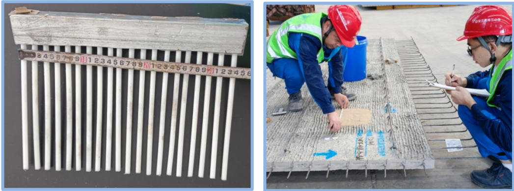
图 9-4 测量制作的拉毛工具与试拉毛粗糙度测试
