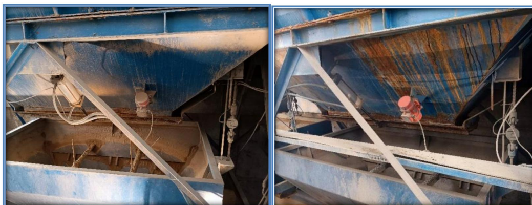
图 9-9 原砂称量仓和新增砂称量仓图
