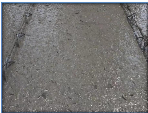
图 7-11 26.5mm 方孔筛碎石颗粒占比 5%砵
