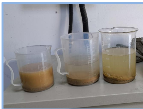
图 7-8 不同含泥量砂泡水后对比
