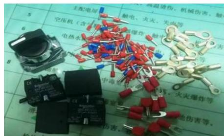
实施目标检查：2022年9月24日小组成员朱祥飞对购买的电气材料数量进行了清点和品质进行检查验收，电缆为江苏上上电缆集团有限公司生产的 CJ86/SC 3X1.5 和 2X1 的船用电缆。旋转开关头、触点基座及常开触点头均为施耐德品牌。现场检测试用，验收合格。
