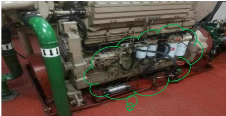
向东康（原动机生产厂家）售后服务商咨询，东康 6BT5.9 型柴油机作为车用发动机，主要配备在东风系列大型货车上。汽车调速是通过油门踏板来联动柴油机油门手柄，控制汽车发动机转速的。
