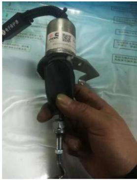
DCEC 停车电磁铁
