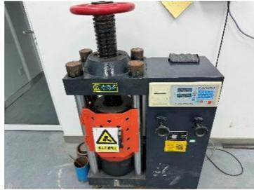
图 15 压力试验机
