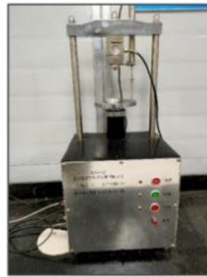
图 24 灌浆材料抗压强度测试
