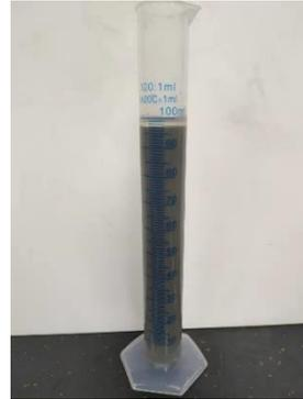
图 22 灌浆材料泌水率测试
