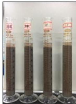
图 28 灌浆材料泌水率测试
