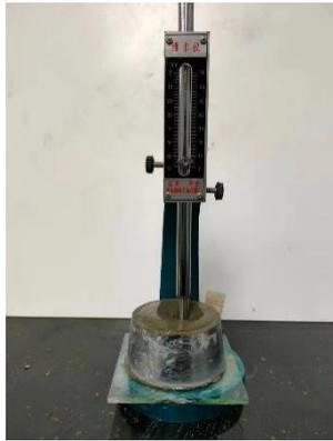
图 27 灌浆材料凝结时间测试
