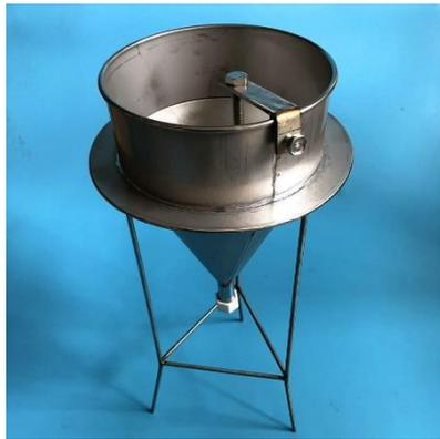
图 23 灌浆材料流动度测试
